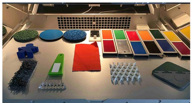
Exemples d'objets et matériaux plastiques de consommation courante testés dans les chambres de vieillissement accéléré.
