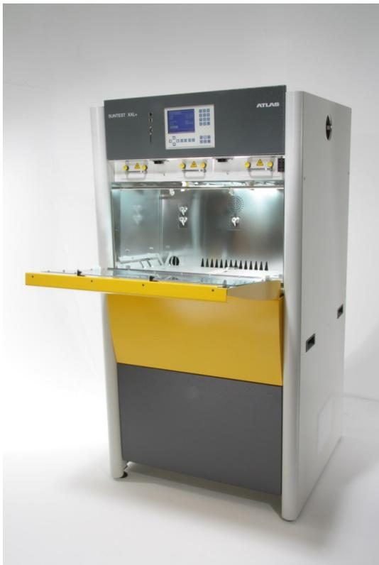
Modèle de chambre climatique Suntest XXL. Les tests sur ces machines ont principalement pour but la prédiction du vieillissement des matières plastiques.
